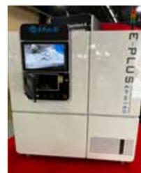
L'EP-M150 utilise un laser à fibre pour faire fondre directement des poudres d'alliages de **Chrome-Cobalt (CrCo)** et de **Titane (Ti)** afin de former des structures et des pièces complexes. L'EP-M150 est parfaitement adaptée au secteur du dentaire pour fabriquer à moindre coût et en masse des éléments fixes, des châssis métalliques, et aussi des éléments implantaires.
